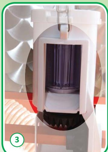
① Il **distributore volumetrico MINIMAX** è facilmente regolabile e consente la distribuzione di fertilizzante a diversi dosaggi mantenendo elevata la precisione distributiva: 50-700 kg/ha
